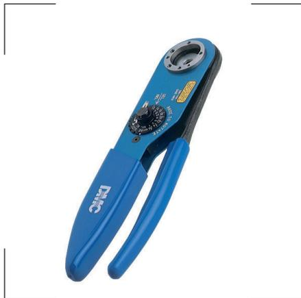
Cumple con el estándar internacional MIL-C-22520/1. El crimpado se realiza con 8 puntos de presión. La herramienta está equipada con un mecanismo de engranajes para controlar el proceso de crimpado. La herramienta debe estar equipada con un posicionador intercambiable (CCTP) según la serie de contactos a crimpar.
