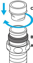
3. Enrosque el cuerpo del racor (D) a la cabeza del racor.
